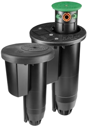
STG-900* Altura total: 36 cm Altura emergente: 8 cm Diámetro: 20 cm Tamaño de entrada: 1½" (40 mm) Acme
