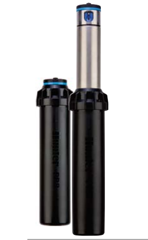
I-20-06-PRB Altura total: 27 cm Altura emergente: 15 cm Diámetro expuesto: 4,5 cm Tamaño de la entrada: ¾"
