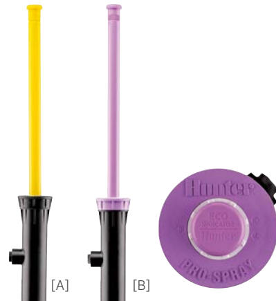
[A] ECO-ID-12 [B] ECO-ID-12-R Altura retraído: 41 cm Altura emergente: 30 cm Diámetro expuesto: 5,7 cm Tamaño de la entrada: ½"
