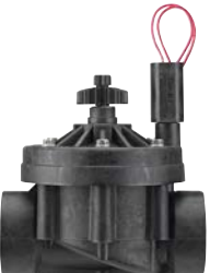
ELECTROVÁLVULA ICV-201G Diámetro de entrada: 2" (50 mm) Altura: 18 cm Longitud: 17 cm Anchura: 14 cm
