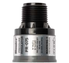
PR-075 Altura total: 5,7 cm Tamaño de la entrada/salida: ¾" Para uso en todos los modelos de aspersor con entrada de ¾", regula la presión a 3,1 bar; 310 kPa
