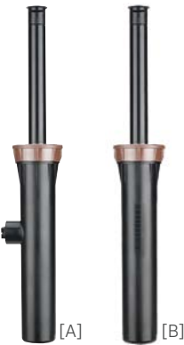
[A] PROS-06-SI-PRS30* [B] PROS-06-PRS30* Altura retraída: 22,5 cm Altura emergente: 15 cm Diámetro expuesto: 5,7 cm Tamaño de la entrada: ½"
