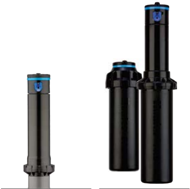
PGP-00-PRB Hauteur totale : 22 cm Diamètre exposé : 4,5 cm Taille de l'entrée : ¾" PGP-04-PRB Hauteur totale : 22 cm Hauteur escamotable : 10 cm Diamètre exposé : 4,5 cm Taille de l'entrée : ¾"
