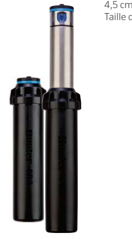
I-20-06-PRB Hauteur totale : 27 cm Hauteur escamotable : 15 cm Diamètre exposé : 4,5 cm Taille de l'entrée : ¾"
