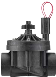
ÉLECTROVANNE ICV-201G Diamètre de l'entrée : 50 mm (2") Hauteur : 18 cm Longueur : 17 cm Largeur : 14 cm
