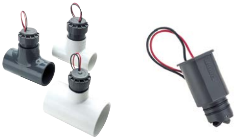
Débitmètre de type turbine, nécessitant un raccord FCT pour l'installation de la canalisation (à commander séparément)
