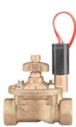
VALVOLA IBV-101G-FS Diametro filetto d'ingresso: 25 mm (1") Altezza: 14 cm Lunghezza: 12 cm Larghezza: 8 cm
