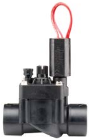
VALVOLA PGV-101-G Diametro filetto d'ingresso: 25 mm (1") Altezza: 13 cm Lunghezza: 11 cm Larghezza: 6 cm
