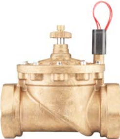
VALVOLA IBV-301G-FS Diametro filetto d'ingresso: 80 mm (3") Altezza: 23 cm Lunghezza: 22 cm Larghezza: 18 cm
